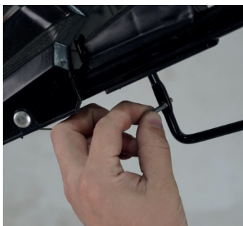
Рис. 2 Крепление троса остановки Двигателя.
