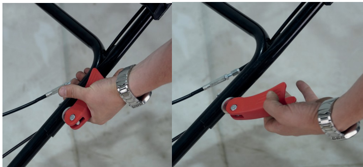
Рис. 1. Крепление верхней части рабочей рукоятки
