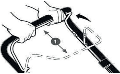
Рис. 15. 1. Рычаг остановки двигателя
