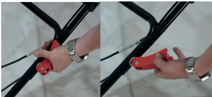
Рис. 1. Крепление верхней части рабочей рукоятки
