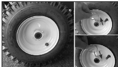
Рис.31 Установка шплинта на левом колесе
