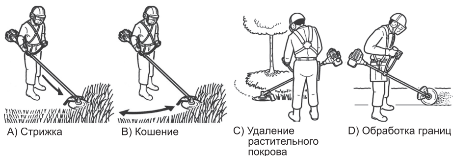
Рис. 10 Основные виды работ триммером
