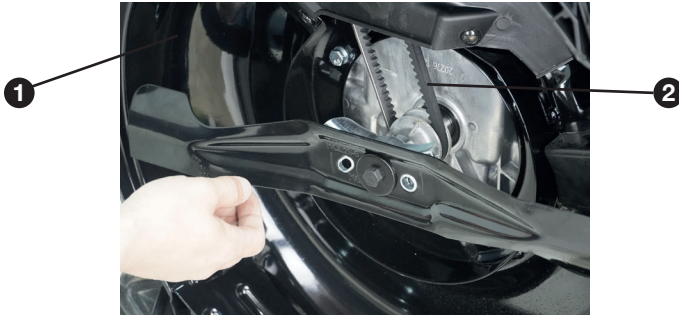
Рис. 29. Проверка состояния ремня привода
