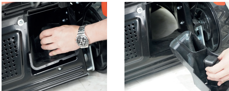
Рис. 8 Заглушка для мульчирования
