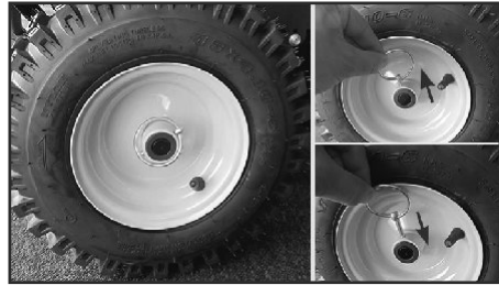
Рис.30 Установка шплинта на левом колесе
