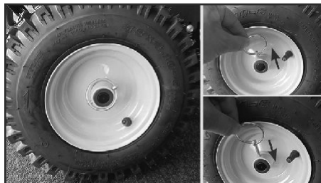
Рис.31 Установка шплинта на левом колесе
