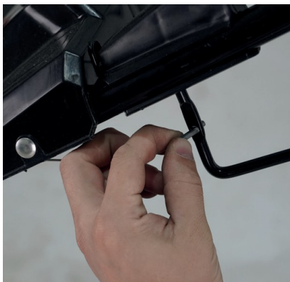
Рис.2 Крепление троса остановки двигателя
