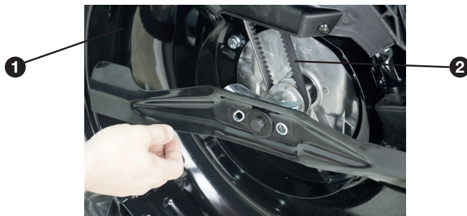
Рис. 29. Проверка состояния ремня привода
